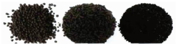
图3 球型炭(左)、柱状炭(中)、无定型炭(右)
