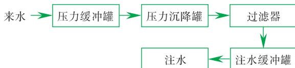
图 1 塔中油田联合站全封闭水处理压力流程
